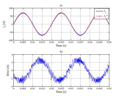
Fig.5. a) Reference and actual output current; b) tracking error
